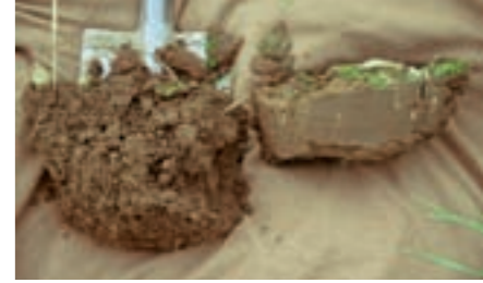
Im linken Bildbereich ist ein gesunder krümeliger Boden zu sehen. Der rechte Bildbereich zeigt denselben Boden, nachdem er von schweren Baumaschinen überfahren und dadurch stark geschädigt wurde.
