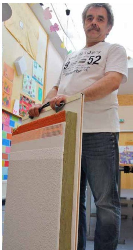
Frank Bauler aus der Mietergruppe zeigt das Wärmedämmverbundsystem.
