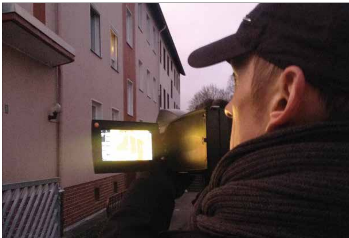
Die Wärmebildkamera bringt's an den Tag: Ein gut gedämmtes Haus erscheint in Blau- und Grüntönen. Wo rote Stellen zu sehen sind, geht viel Energie verloren. Ende November konnten Hausbesitzer kostenlos sogenannte Thermografiebilder machen lassen.
