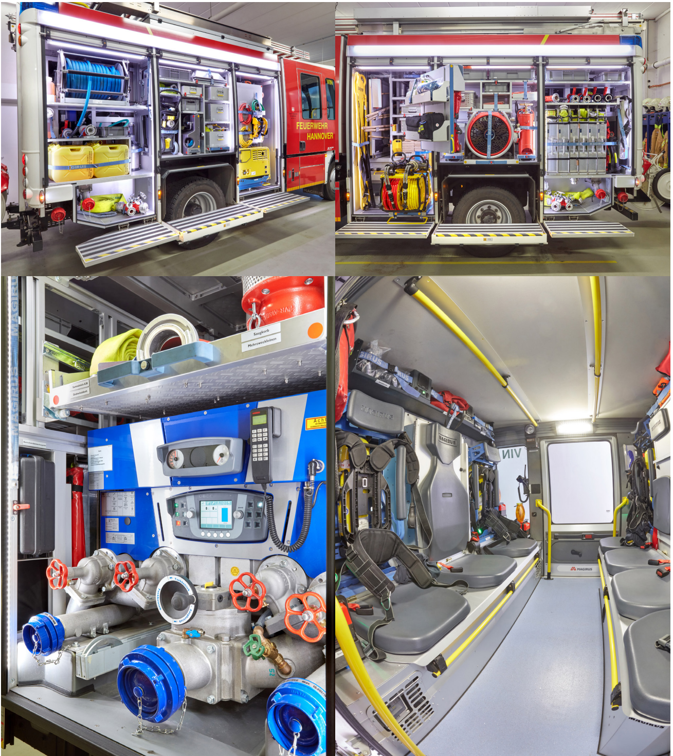
Pumpen- und Geräteraum sowie Mannschaftskabine des HLF20 der Ortsfeuerwehr Vinnhorst (Foto: Feuerwehr Hannover)
