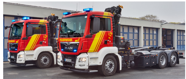
Die Nachlaufachse der dreiachsigen WLF-K ist gelenkt und liftpbar (Feuerwehr Hannover)
