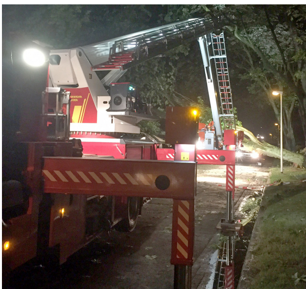
Einsatz einer Teleskopmastbühne an einem umgestürzten Baum im Stadtteil Bult (Foto: Feuerwehr Hannover)
