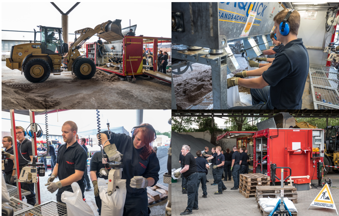
Einsatzkräfte können in kurzer Zeit größere Mengen an Sandsäcken mit der Sandsackfüllmaschine füllen (Fotos: Uwe Dillenberg)
