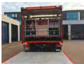
Über die hydraulische Ladebordwand können die Rollwagen mit medizinischem Material und Geräten schnell entladen werden. (Foto: Feuerwehr Hannover)
