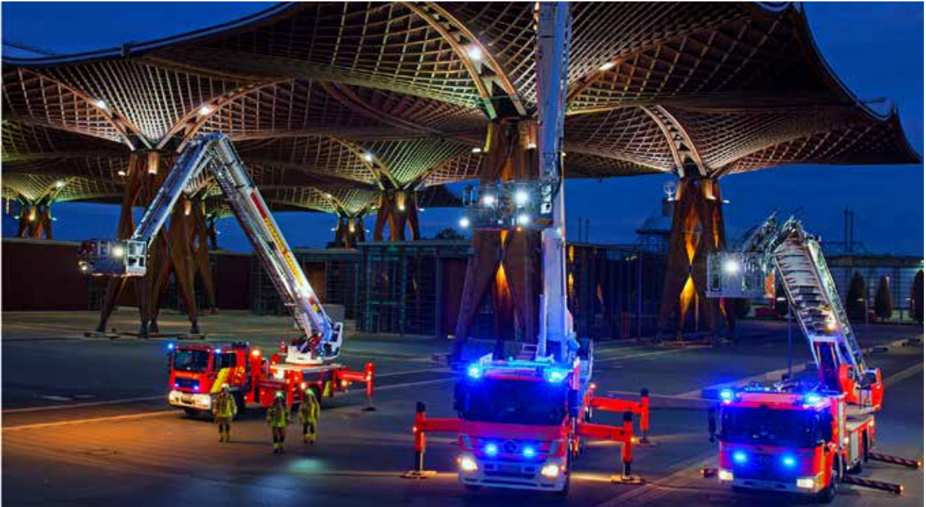
Die Teleskopmastbühne der Ortsfeuerwehr Misburg und der Rettungswache 5 sowie eine Drehleiter mit teleskopierbarem Gelenkteil vor dem Expo-Dach auf dem Messegelände (Foto: Ulrich Reinecke)
