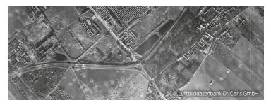
Deuten die Luftbilder auf Blindgängerverdachtspunkte hin, so müssen diese durch technische Sondierungen weiter erforscht werden. Dazu werden Tiefenbohrungen mit einem Durchmesser von 110 mm in einem vorgegebenen Raster um den Verdachtspunkt gebohrt und mittels Magnetfeldsonden überprüft.
