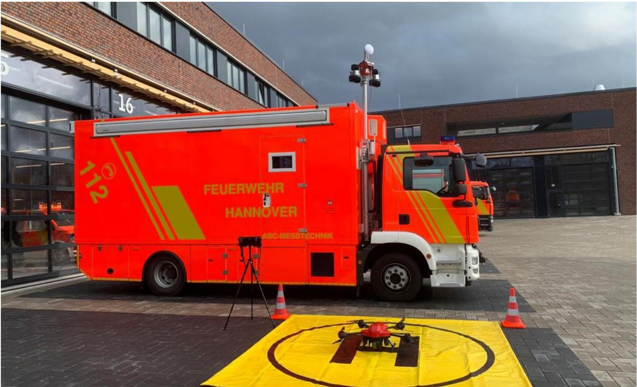
Komplettaufbau UAS-System auf dem GW-Mess (Foto: Feuerwehr Hannover)
