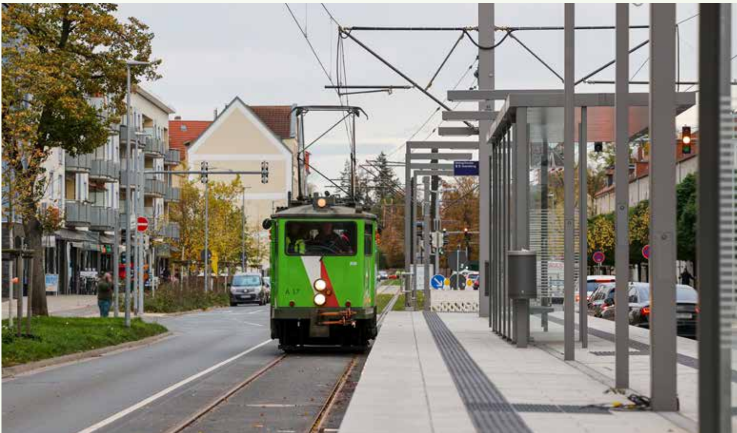
Die ersten Bahnen, die die Strecke befahren, nehmen keine Fahrgäste mit. Es ist der Schienenschleifwagen der ÜSTRA, der die Strecke am 2. November 2023 als erstes testet und den Rost am noch unbefahrenen Gleis entfernt.
